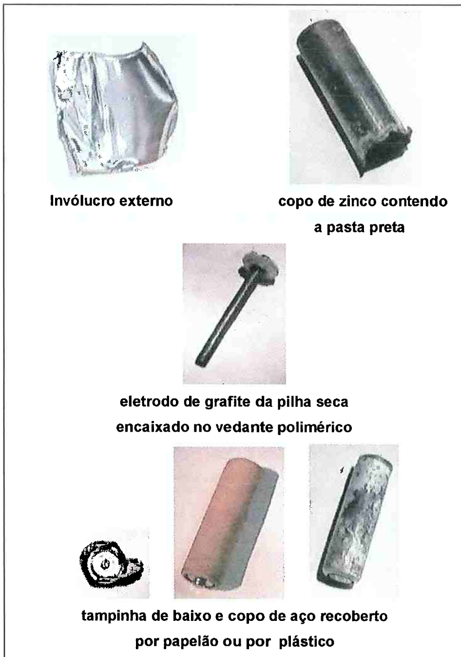
Figura 8. Partes de uma pilha seca desmontada
