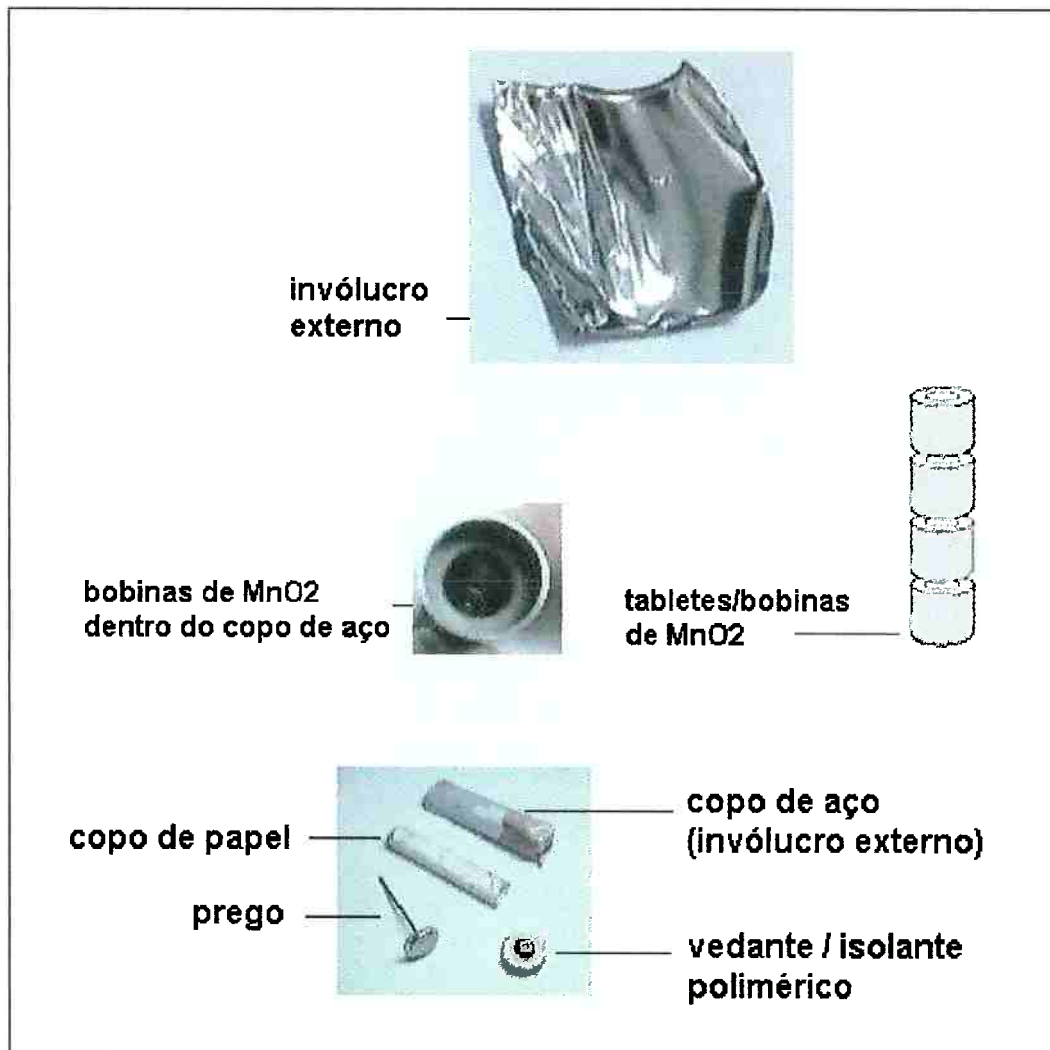
Figura 9. Partes de uma pilha alcalina desmontada
